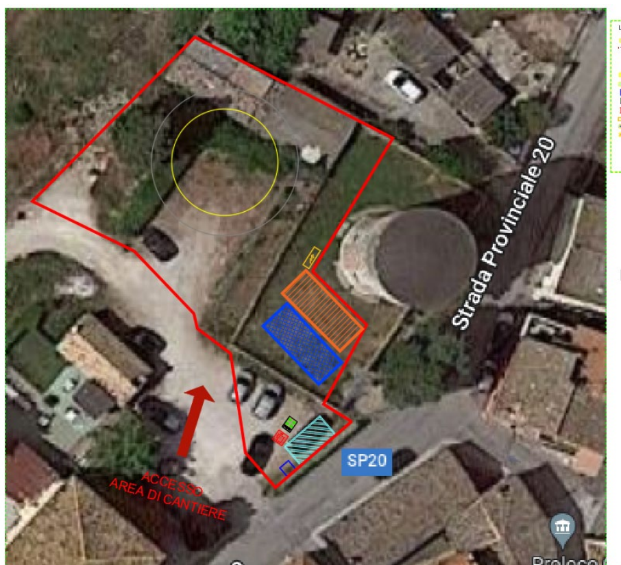
Ipotesi di logistica cantiere realizzazione nuovo serbatoio
